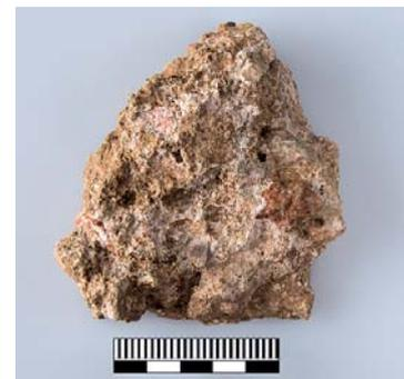
Abb. 10b: Unterseite/Bruchseite eines opus signinum-Brockens mit Gemenge aus Mörtel, Ziegel- und Keramikfragmenten sowie Lockersedimenten
