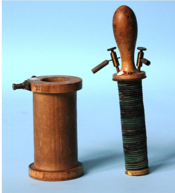
**Beschreibung:** Versuch zum Zeigen der Induktion. Wird die dünne Spule mit Gleichstrom betrieben, hat sie die Wirkung wie ein Stabmagnet. Mit Wechselspannung kann das Funktionsprinzip des Transformators gezeigt werden.
