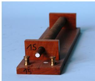
**Beschreibung:** Lange Spule mit Eisenstab. Beim Anlegen einer Spannung wird der Stab in die Spule hineingezogen, falls er nicht symmetrisch positioniert ist.
