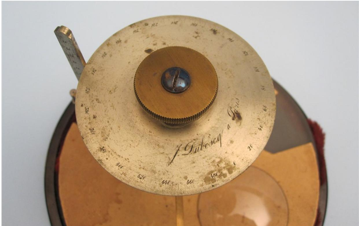
**Beschreibung:** Sphärometer, zur Messung der Dicke bzw. des Krümmungsradius' von Linsen. Auf der Messscheibe befindet sich der Schriftzug: „J. Duboscq a Paris“. Eine Umdrehung der Messscheibe entspricht 0,5 mm, ein Strich auf der Scheibe entspricht 1  $\mu\text{m}$ . Der Glassturz ist am unteren Rand an einer Stelle abgeschlagen und hat von dort weg einen Sprung.
