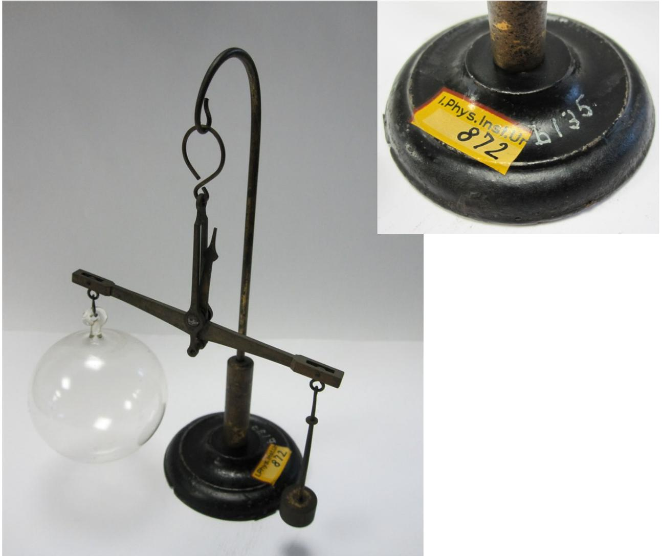
**Beschreibung:** Dasymeter, dient zum Zeigen des Auftriebs an Luft. Wird es in einen evakuierbaren Glassturz gestellt und dieser evakuiert, neigt sich die Seite mit der Glaskugel wegen des fehlenden Auftriebs nach unten.
