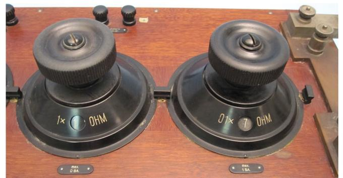
**Beschreibung:** Präzisionsmessbrücke von Norma, fünf Drehschalter (1000  $\Omega$ , 100  $\Omega$ , 10  $\Omega$ , 1  $\Omega$  und 0.1  $\Omega$ ).
