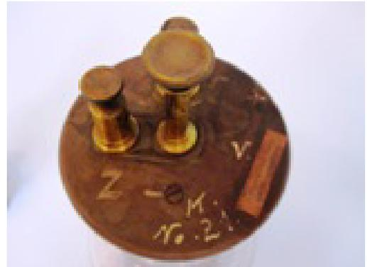
**Beschreibung:** Kleines und größeres galvanisches Element, vermutlich Grenet-Elemente (C-Zn-C,  $\text{NaCr}_2\text{O}_7 + \text{H}_2\text{SO}_4 + \text{H}_2\text{O}$ ).
