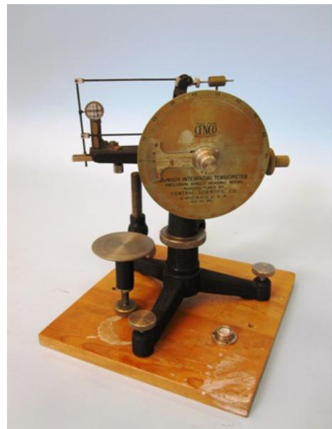
**Beschreibung:** Oberflächenspannungsmessgerät (Torsionswelle, steigbügelartig), Aufschrift: „TRADE MARK CENCO REG.U.S. PAT. OFF. DUNOÜY INTERFACIAL TENSIO METER PRECISION DIRECT READING MODEL MANUFACTURED BY CENTRAL SCIENTIFIC CO. CHICAGO, U.S.A. SER. NO. 951“.
