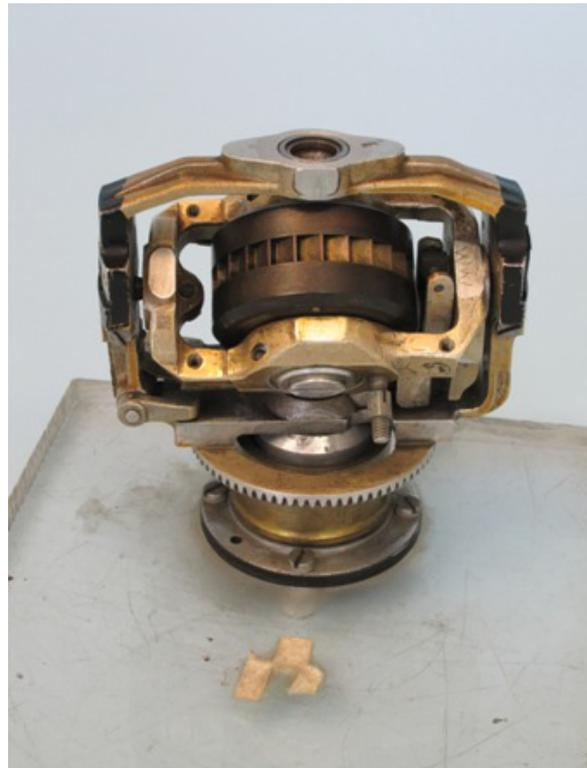
**Beschreibung:** Kurskreisel aus abgeschossenem Bomber. Antrieb mit Pressluft, wird vor dem Start des Flugzeuges angeworfen, eingestellt und behält unabhängig von der Fluglage die Richtung bei.
