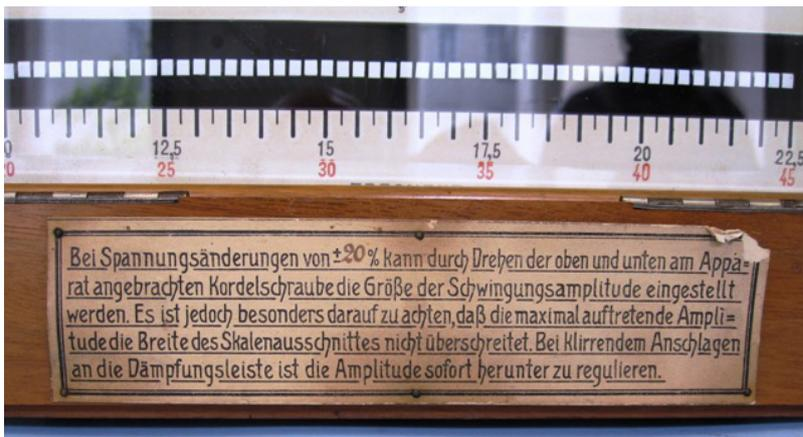
**Beschreibung:** Zungenfrequenzmesser, Aufschrift FREQUENZMESSER SYSTEM FRAHM, z.B. wurde verwendet für den Versuch Seitenbandmodulation: 50 Hz Signal wird angeschlossen und ein bis zweimal pro Sekunde wird mit einem Morse-Taster der Strom unterbrochen, es entstehen Oberwellen, Differenzschwingung (48 Hz) und Summenschwingung (52 Hz).
