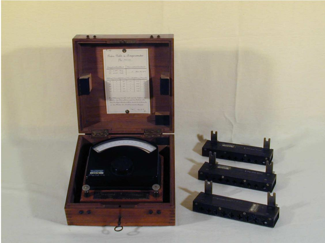
**Beschreibung:** Präzisionsmillivolt und Amperemeter mit 3 Shunts in Holzkassette
