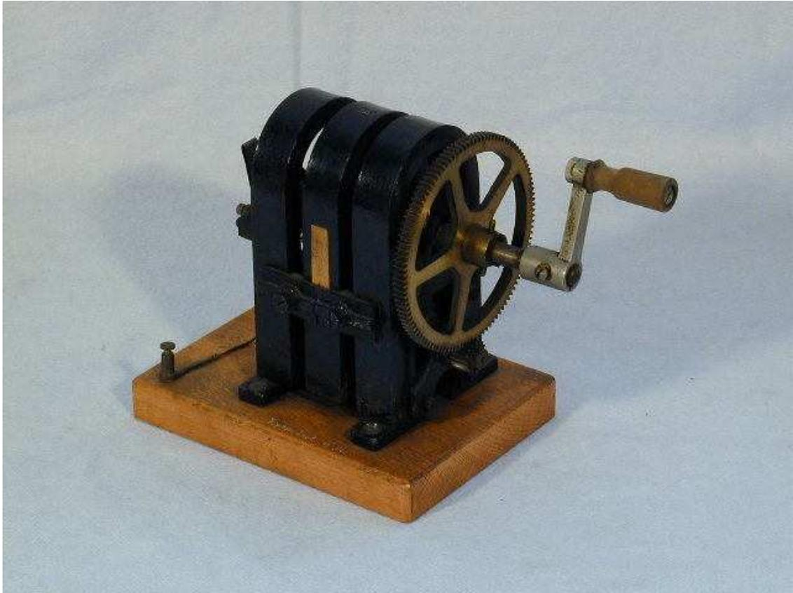
**Beschreibung:** Magnetelektrische Maschine mit 3 Magneten
