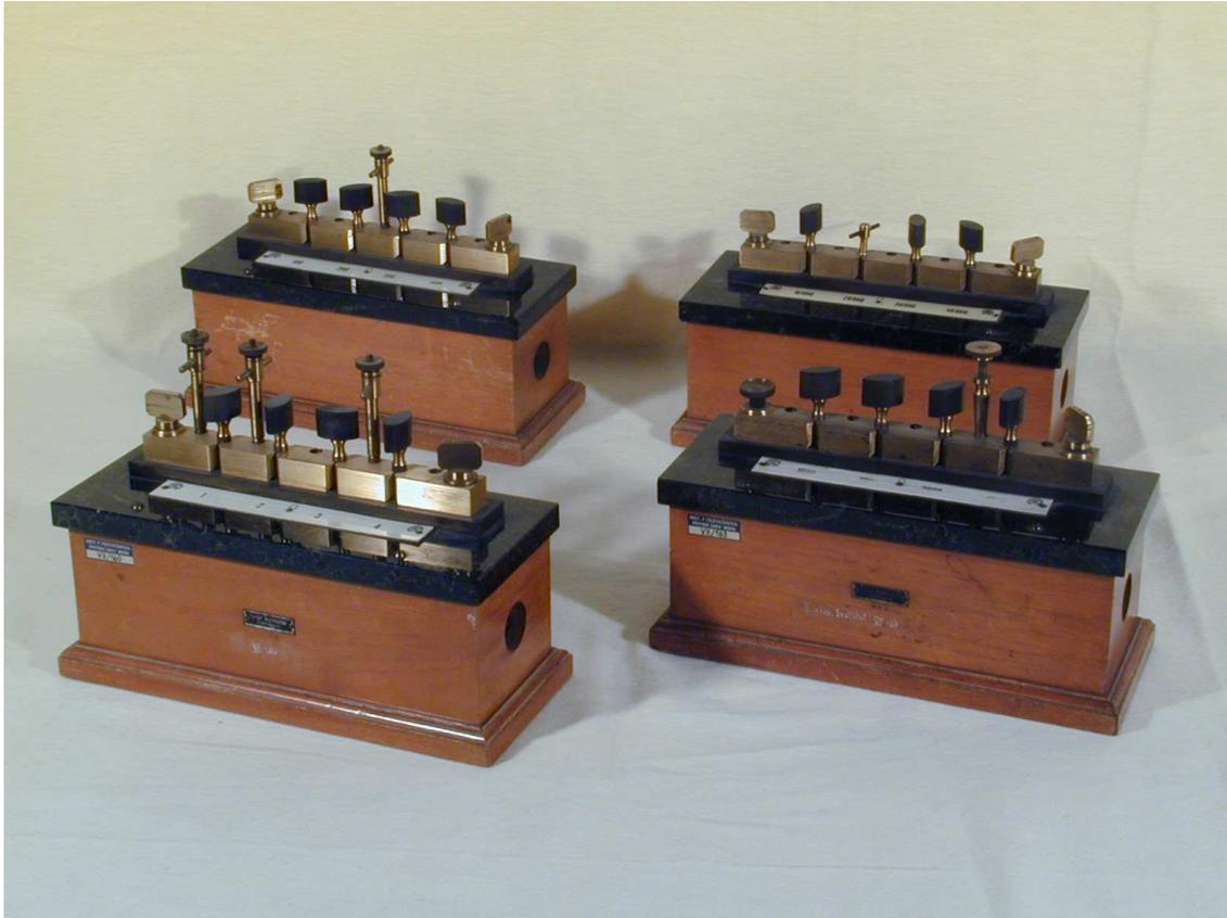
**Beschreibung:** Technische Stöpselwiderstände mit Marmorplatte 534, 10 Ohm 536, 1000 Ohm 537, 10 000 Ohm 538, 100 000 Ohm
