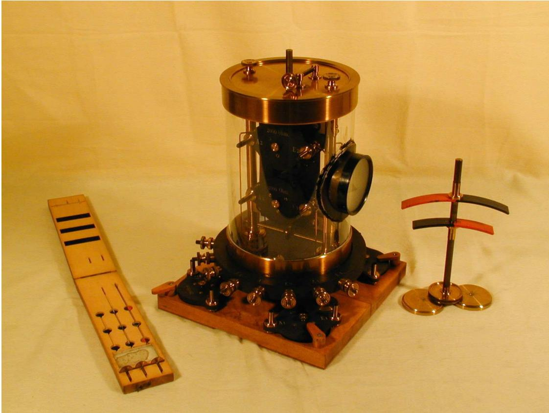
**Beschreibung:** Vierspuliges Spiegelgalvanometer nach Du Bois und Rubens in Holzkassette mit Kompensationsmagnet. 4 Spulen a 20 Ohm und 4 Spulen a 2000 Ohm, Schatulle für 3 Reservenadeln, eine vorhanden.
