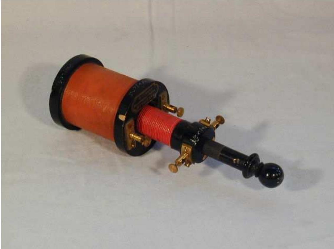
**Beschreibung:** Induktionsspule 93 Ohm, Sekundärspule 0,06 Ohm, Eisenkern
