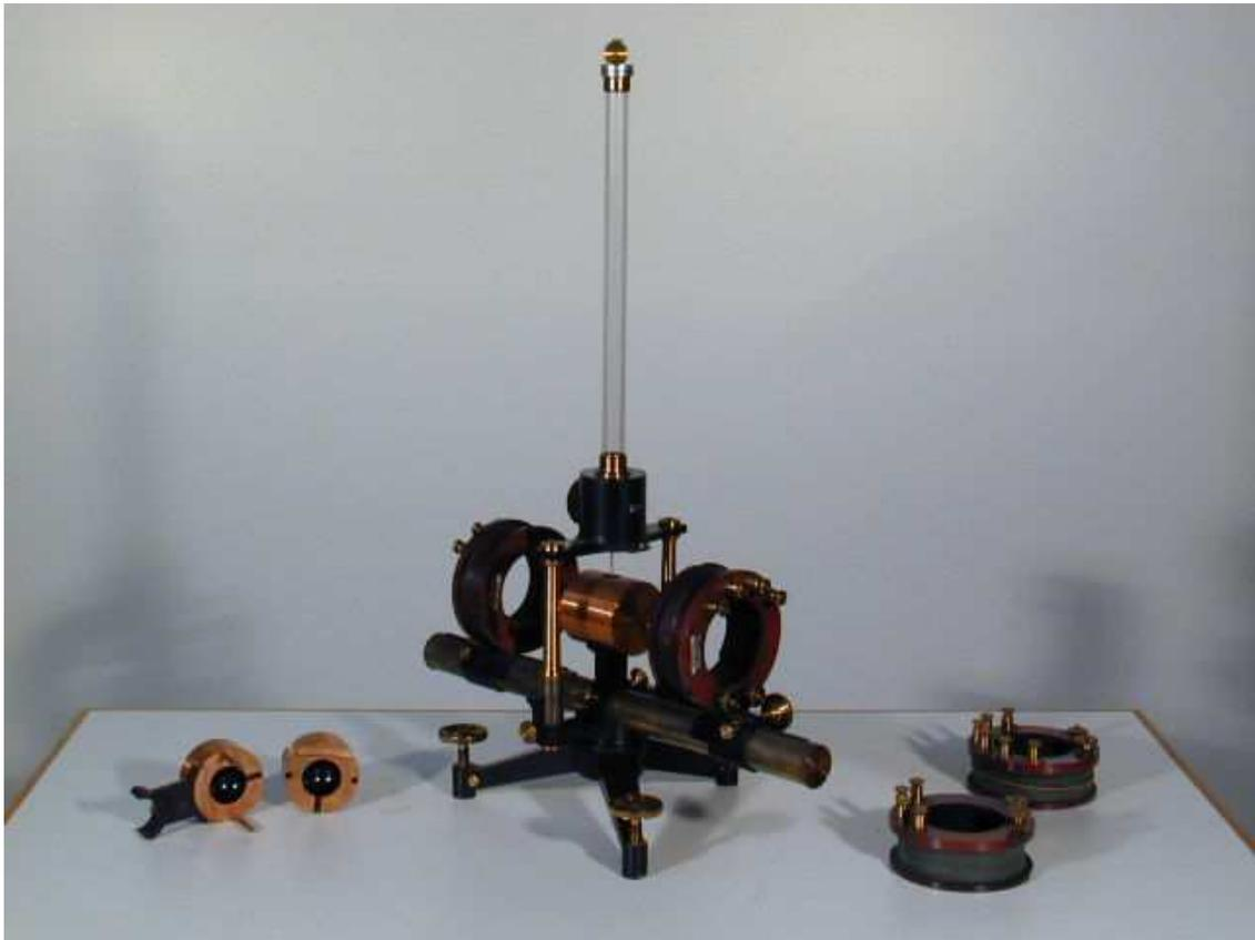
**Beschreibung:** Wiedemannsches Galvanometer mit 2 Wechselpulen und einem Wechselpanzer
