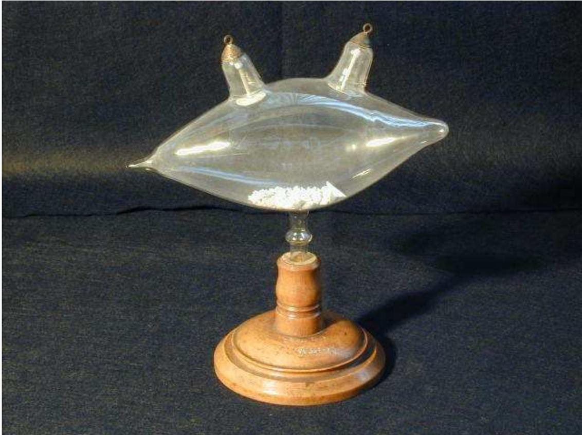
**Beschreibung:** Pulujsches Entladungsrohr mit phosphoreszierender Substanz auf Holzfuß
