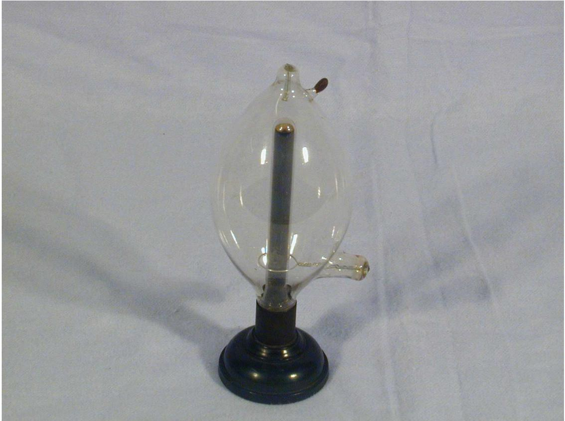
**Beschreibung:** Ionenablenkungsapparat mit Vertikalmagnet
