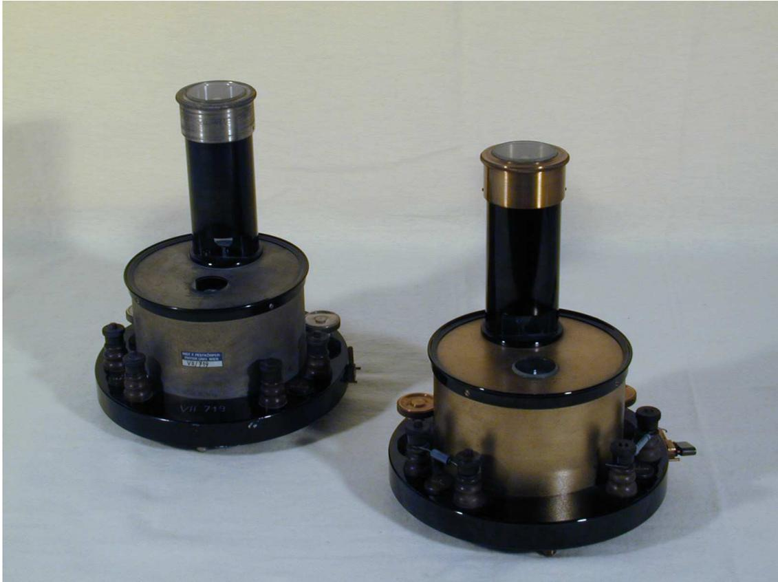
**Beschreibung:** Spiegelgalvanometer mit Doppelspule No 730;  $R_1 = \text{ca } 2,0 \text{ Ohm}$ ,  $R_2 = \text{ca } 2,7 \text{ Ohm}$
