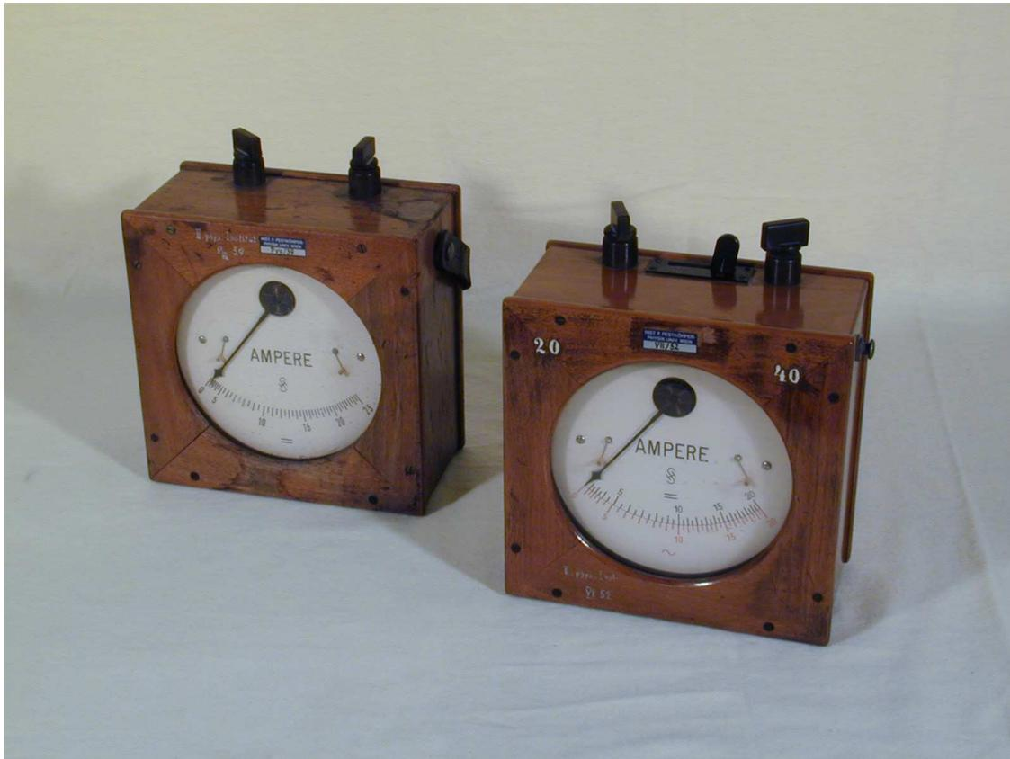
**Beschreibung:** Technische Amperemeter 407090, für Gleichstrom und Wechselstrom 20 A oder 40 A 534338, für Gleichstrom 25 A
