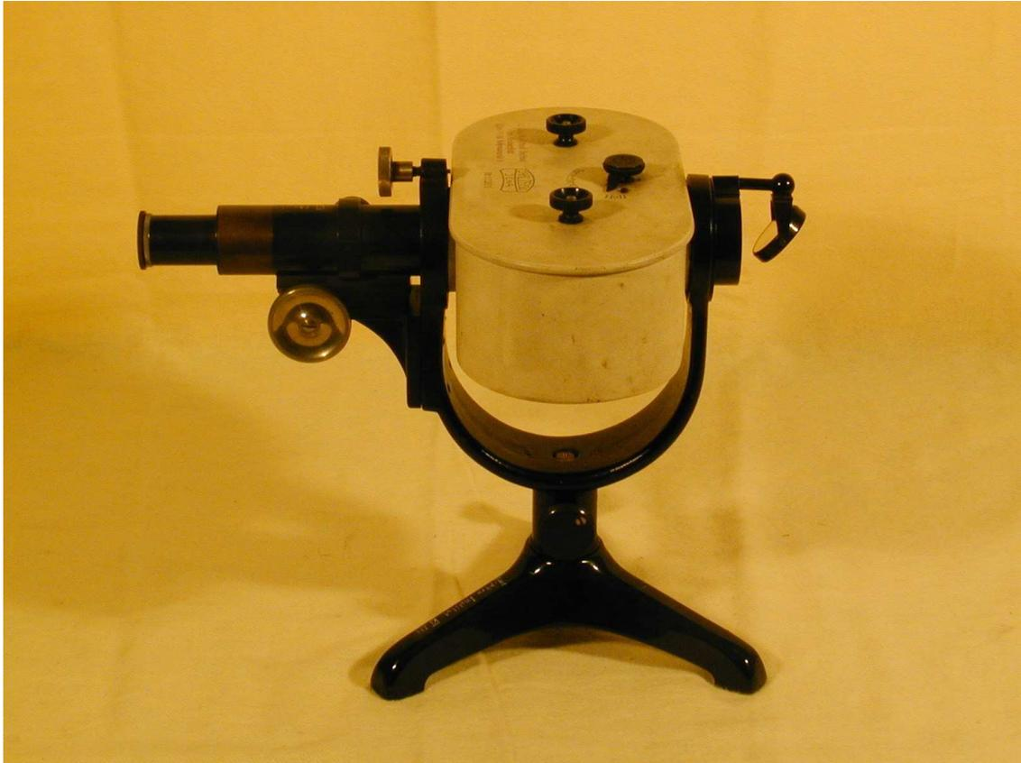
**Beschreibung:** Schleifengalvanometer in Holzkassette (unvollständig)
