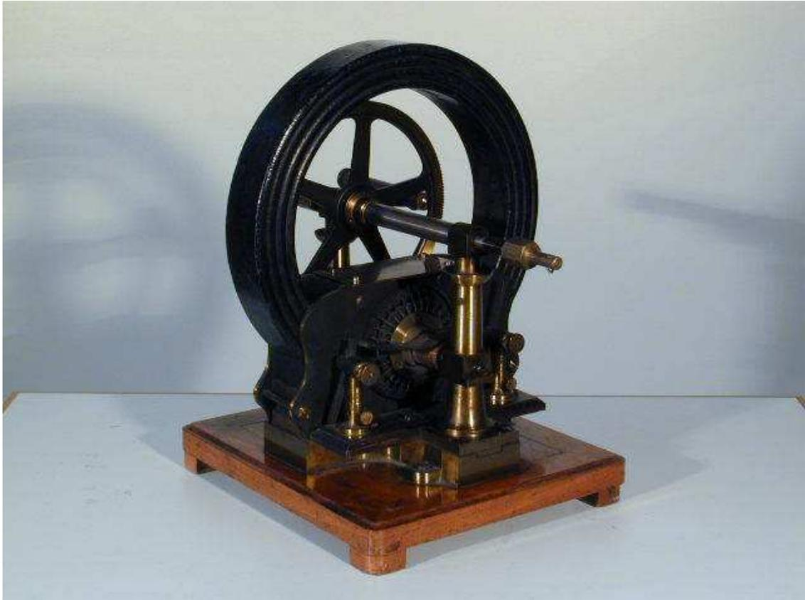
**Beschreibung:** Demonstrationsmotorgenerator mit Grammeanker
