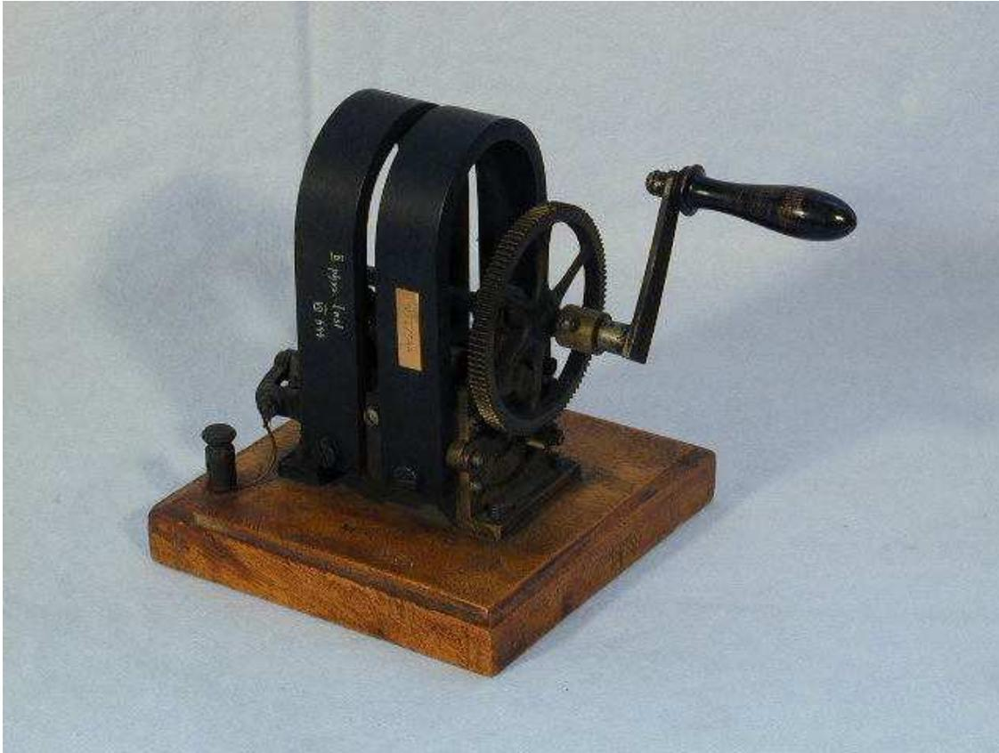
**Beschreibung:** Magnetelektrische Maschine mit 2 Magneten
