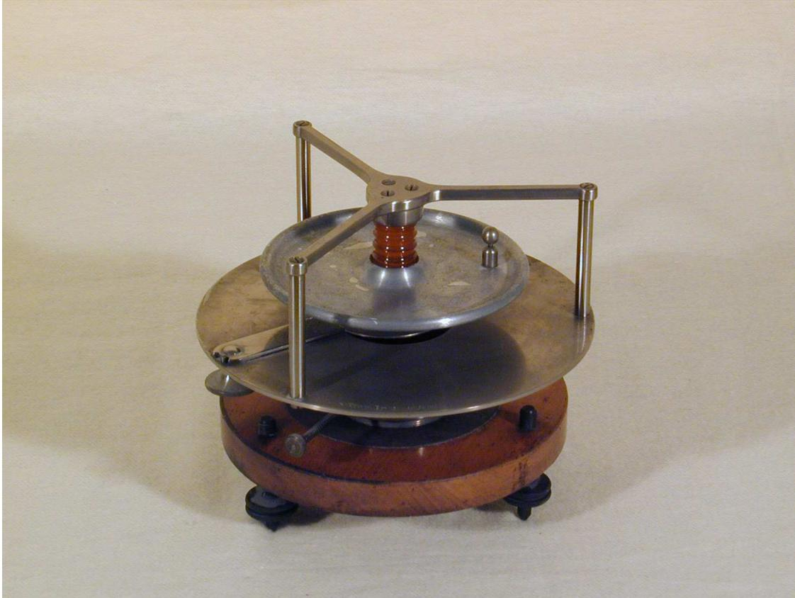
**Beschreibung:** Hochspannungsaufsatz zum Zweifadenelektrometer nach Wulf
