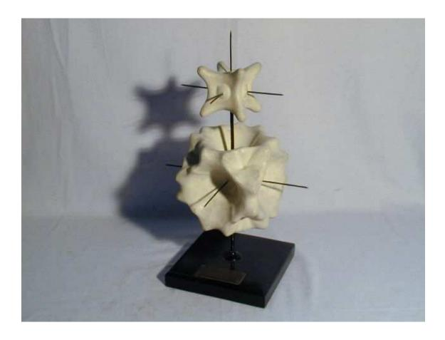
**Beschreibung:** Festigkeitskörper und Dehnungskörper eines Cu<br/> Einkristalles nach Czochraski. 2mm Achsenabstand = 1kg/mm2 Festigkeit bzw. 1
