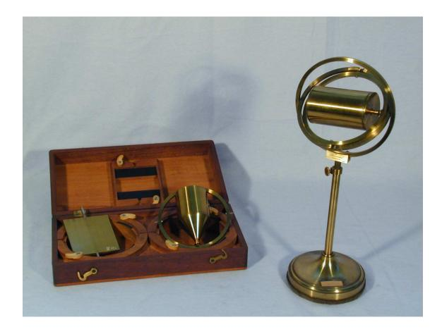
**Beschreibung:** Apparat zur Luft Widerstandsmessung mit Holzkassette mit 3 Widerstandskörpern Gestell mit Kardanischer Aufhängung Zylinderkegelkörper Zylinderkörper Plattenkörper
