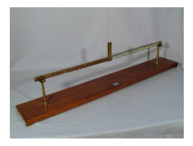
Beschreibung: Apparat zur Demonstration der Wärmeleitung aus Fe-Cu
