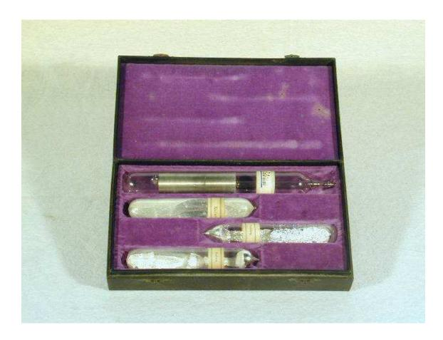
Beschreibung: Kassette mit vier abgeschmolzenen Glasröhren mit Ca, K, Na und KaNa
