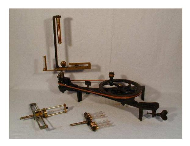
Beschreibung: Schwungmaschine mit Zubehör zur Demonstration der Zentrifugalkraft
