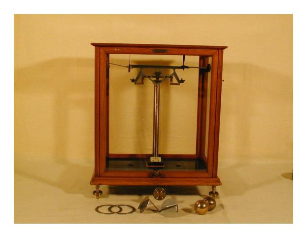
Beschreibung: Analytische Waage umgebaut für Gravitationsmessungen
