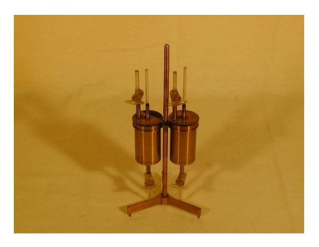
**Beschreibung:** Stefanscher Originalapparat vermutlich zur Messung der Wärmeleitfähigkeit von Gasen
