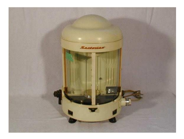
Beschreibung: Halbautomatische Einhebelwaage
