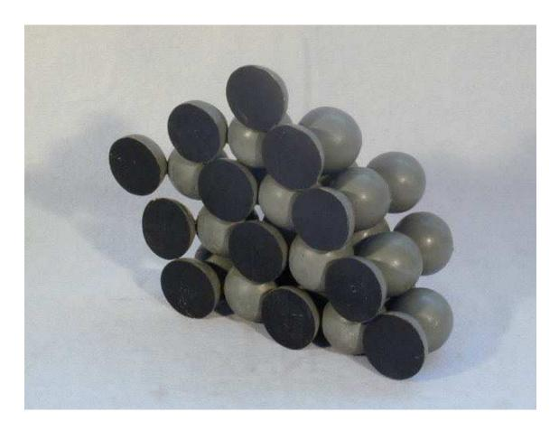
Beschreibung: Gittermodell dichteste Kugelpackung, zerlegbar, aus Holzkugeln
