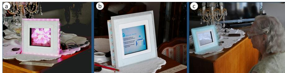
Abb. 6 Ambiente Rahmenbeleuchtung zur „Untermalung“ des Bildinhalts (6a) bzw. zur Ankündigung neue Empfehlungen einer bestimmten Kategorie (6b und 6c)
