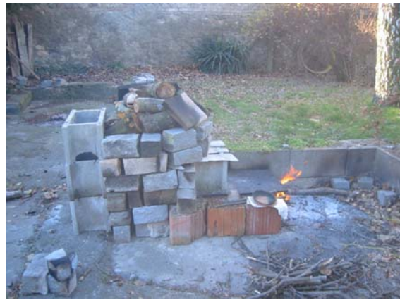
Abb. 14: der Ofen wird um das Gefäß herumgebaut.
