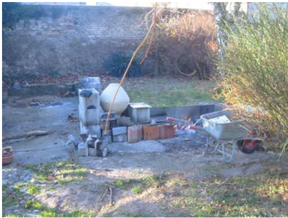
Abb. 13: Gefäß in der Aufwärmphase. Rechts, leicht von der Scheibtruhe verdeckt, das Aufwärmfeuer noch aushalb des Schürkanals.
